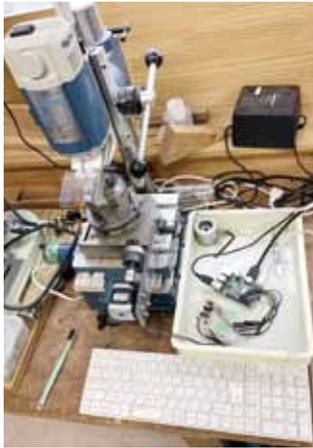
写真はフライス盤の下にある回転台を指定した角度で回す装置で、ラズパイとステッピングモーターで雑にブレッドボードで作っていて、チャックに挟んだ材料を六角形（ハース式で表した糖の構造をイメージする）や各種のアミノ酸の違いを意識した形に成型するものです。別にそこまでしなくてもいいとは思いますが、ついしてしまうのは頭が固くなっているのかなと、今のところ少しは自覚しているつもりですがなんともです。でも、このようにモノづくりをしていると、そのちょっと変な物体そのものや、やっている事に興味を持った方とのつながりが新たにできて、いろんな経験を持った方との輪が広がってなんだか心地よいです。妻には、お父さんの付き合っている人は面白い人しかいないねといつも言われています。心当たりの方はすみません。これは、最大の誉め言葉とっておりますので。ここまでが、一応収入のある仕事についてです。
