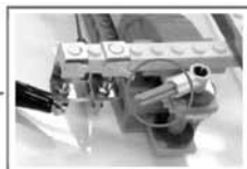
棒の動きを制御してスイッチを動かす
